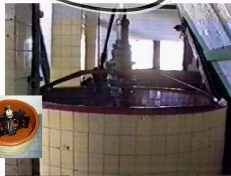
Estaban revestidos con azulejos, tanto en el exterior como en el interior. El batido se realizaba gracias a unas grandes palas de fundición que se movían en direcciones opuestas mientras que todo el sistema giraba.
