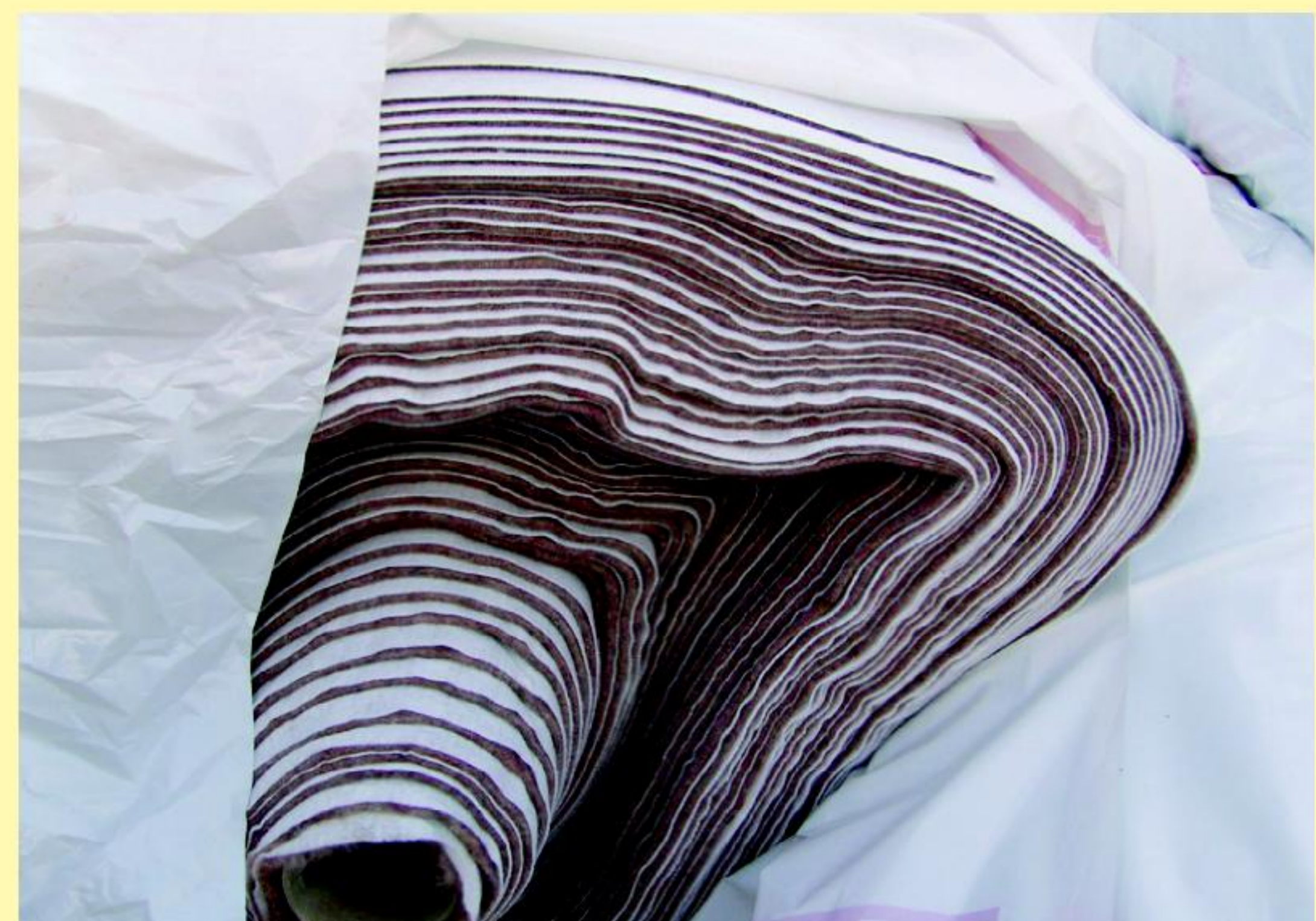
Geotextil que separará el plástico de la grava
