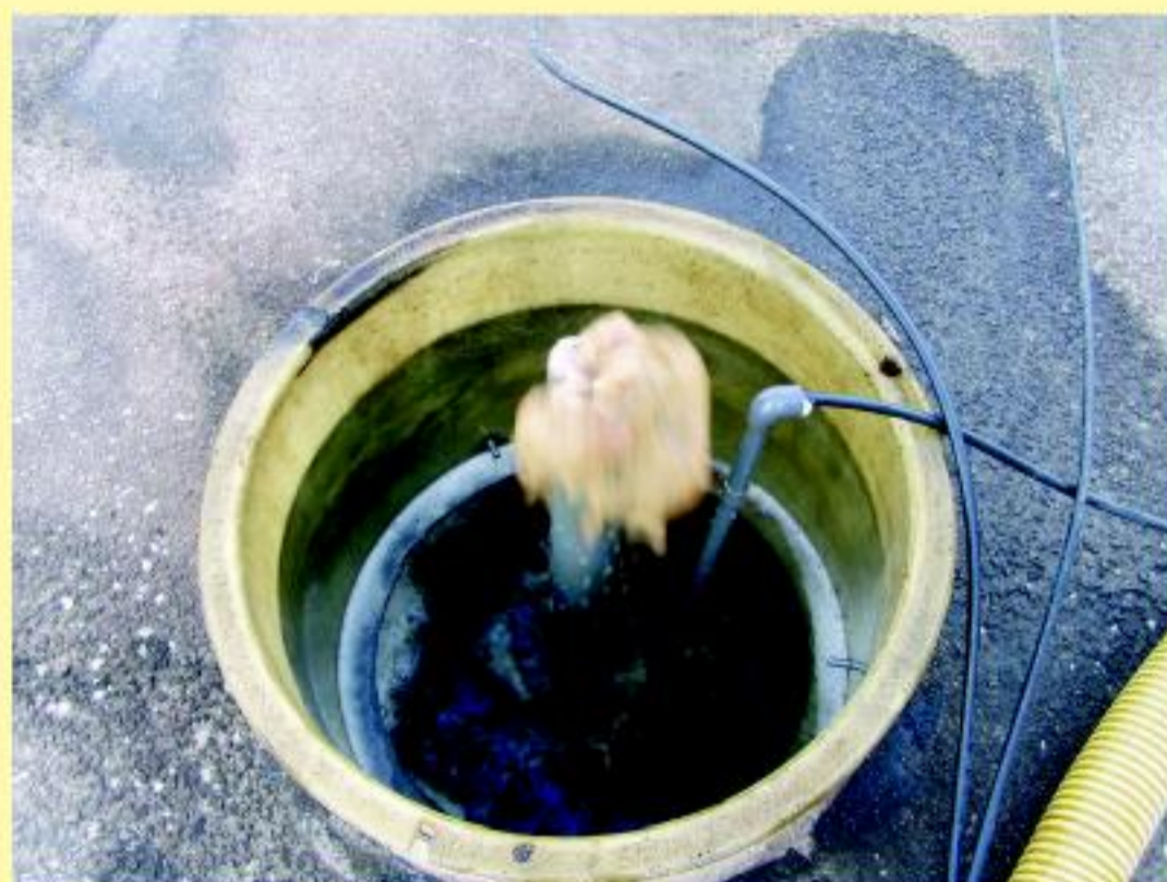
El bombeo de aire y otros recursos impiden las fermentaciones durante el almacenaje.
