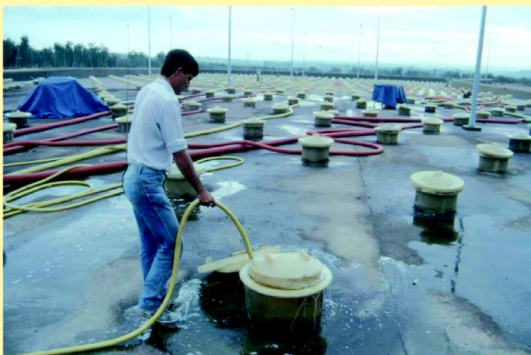
La fermentación se desarrolla en recipientes de 10.000 litros de capacidad enterrados en el suelo.
