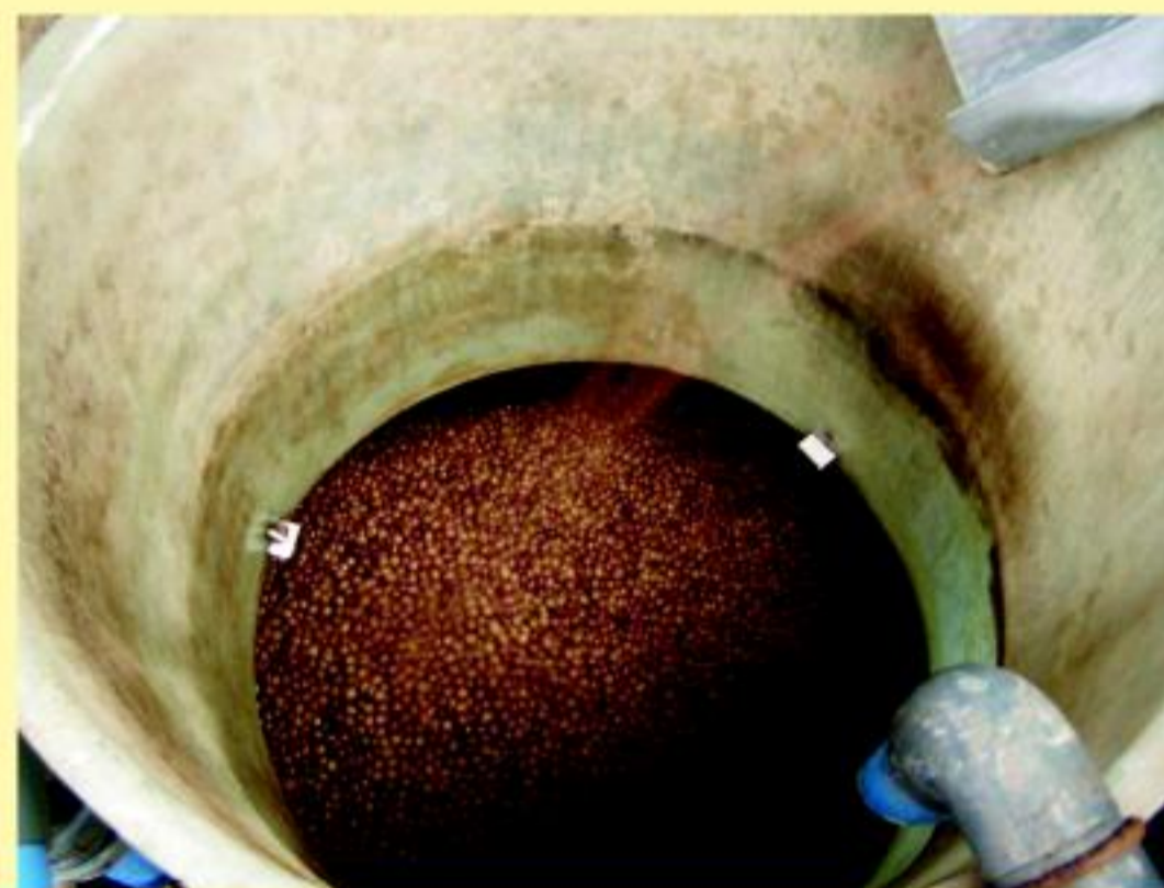
Aceitunas clasificadas con anterioridad a la cocción. Están oscuras por la oxidación ocurrida durante el almacenaje.
