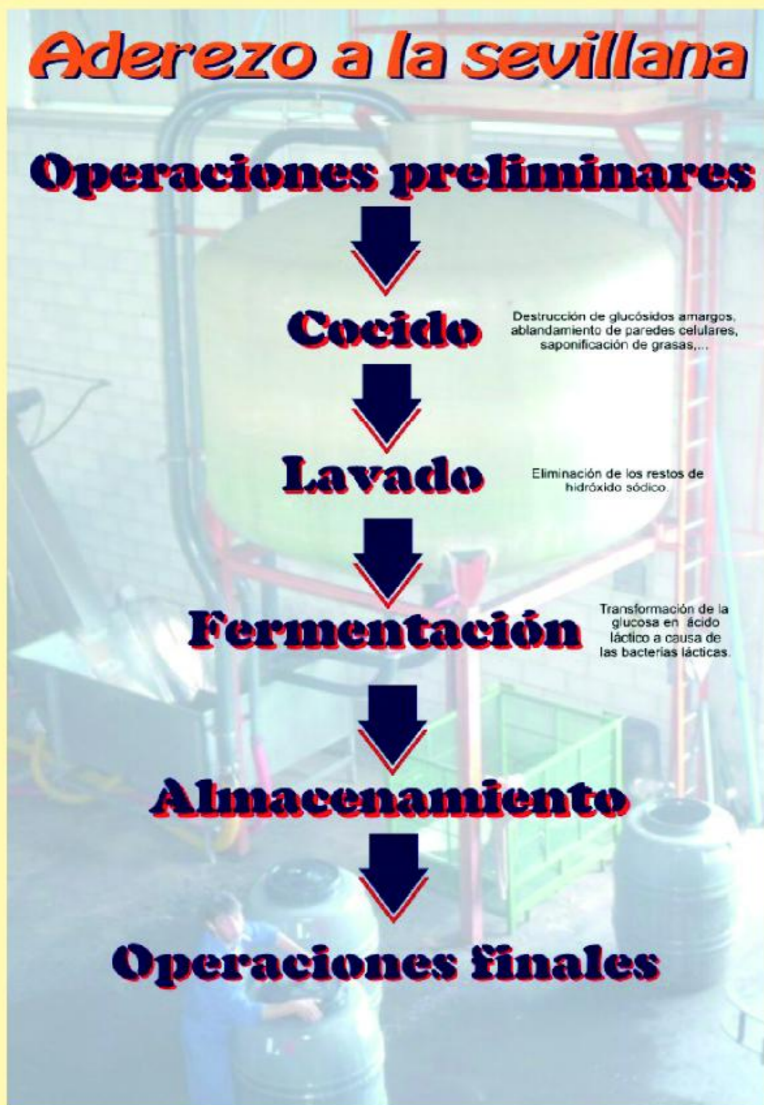
El avance de la cocción se determina catando las aceitunas.
